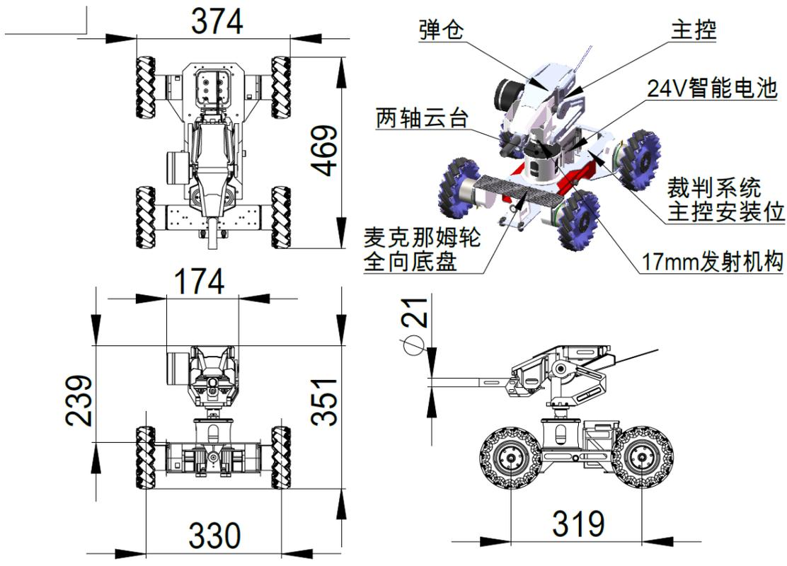
示例说明：底盘采用XXXX悬架，麦克纳姆轮四轮独立驱动全向移动方案，云台为两轴，摩擦轮式17mm弹丸发射机构，电池放置在底盘中后部，主控在云台下方，采用底盘跟随云台的控制方式。通过XXXX方案，具有自动识别打击目标的功能。通过XXXX方案，有自动避障和自动移动，或跟随功能。
